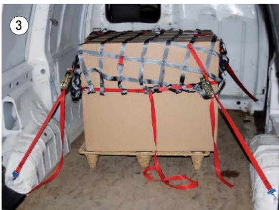
Achten Sie bitte auf eine möglichst gleichmäßige und flächige Spannungsverteilung im Netz. Positionieren Sie Ladung und Netz so, dass in den Netzgurten die LC Netz Befestigungspunkt nicht überschritten wird **(Bild 3)**.
