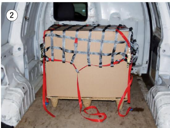
Ziehen Sie das Ladungssicherungsnetz stramm über die Ladung **(Bild 2)**. Die Maschen sind für die Aufnahme von Zurrkräften nicht geeignet!
